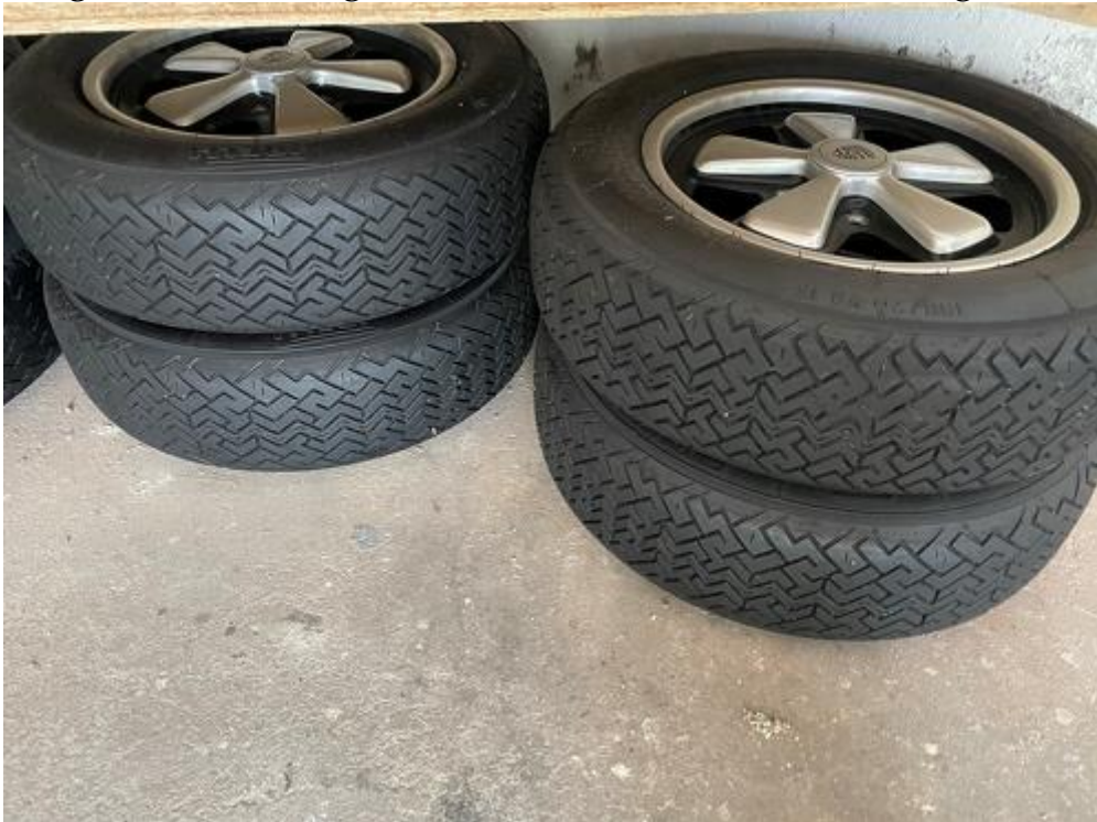
original Fuchs Felgen im klassischen Design aufgearbeitet eloxiert/schwarz mit Bereifung Michelin XWX 185/70 R15
