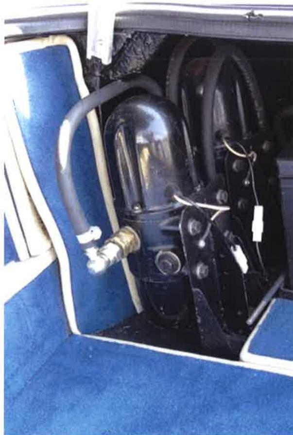
Benzinpumpe rechts angebracht
