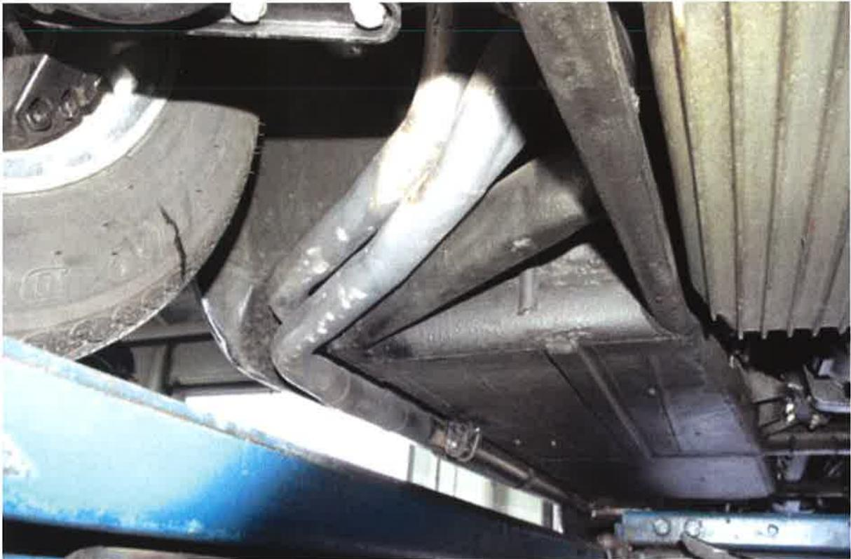
Abgasführung im Schweller, Unterboden rechts
