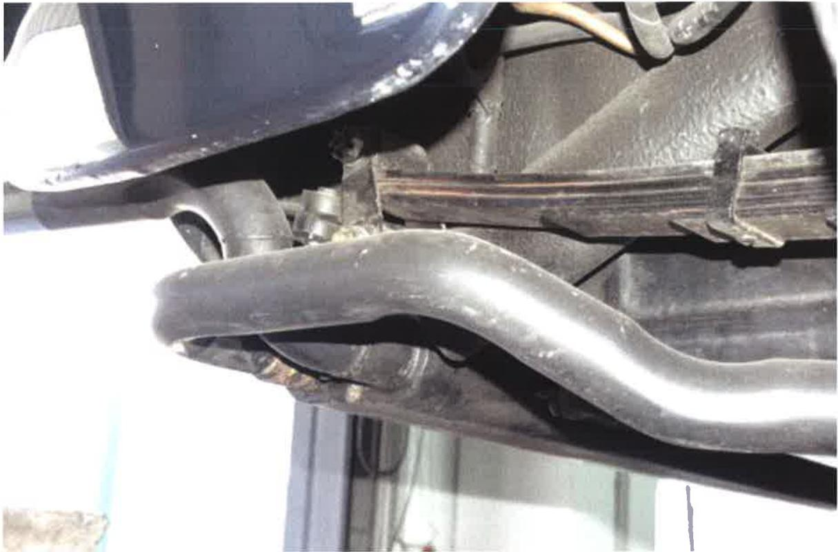
Hinterachsaufnahme, Blattfeder, Abgasanlage, Rahmen
