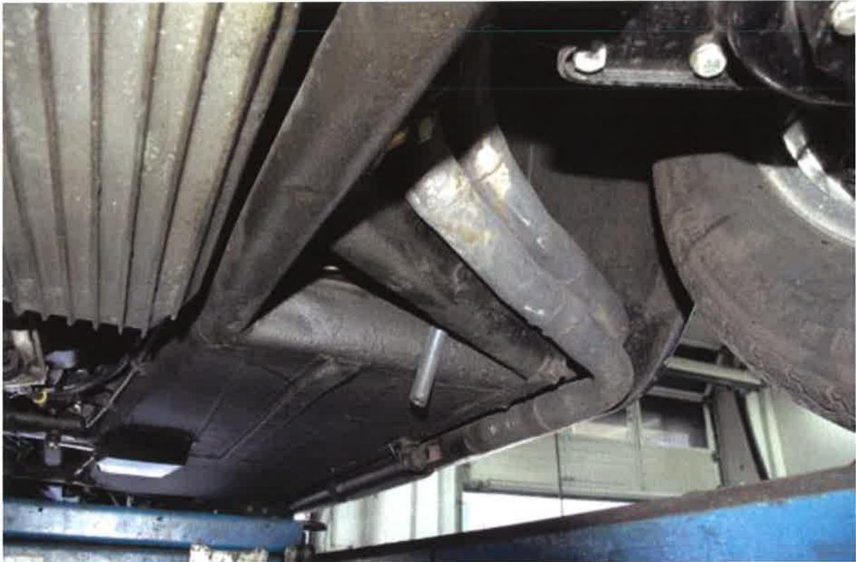
Abgasführung im Schweller, Unterboden links
