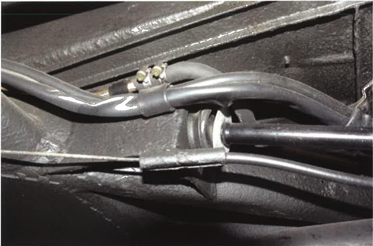
Hinterachsabstützung, Handbremsseil, Kabelführung
